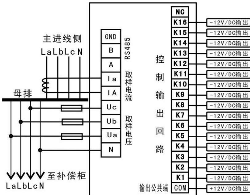
当单个电流互感器时分补控制器做共补控制器用接线方式
