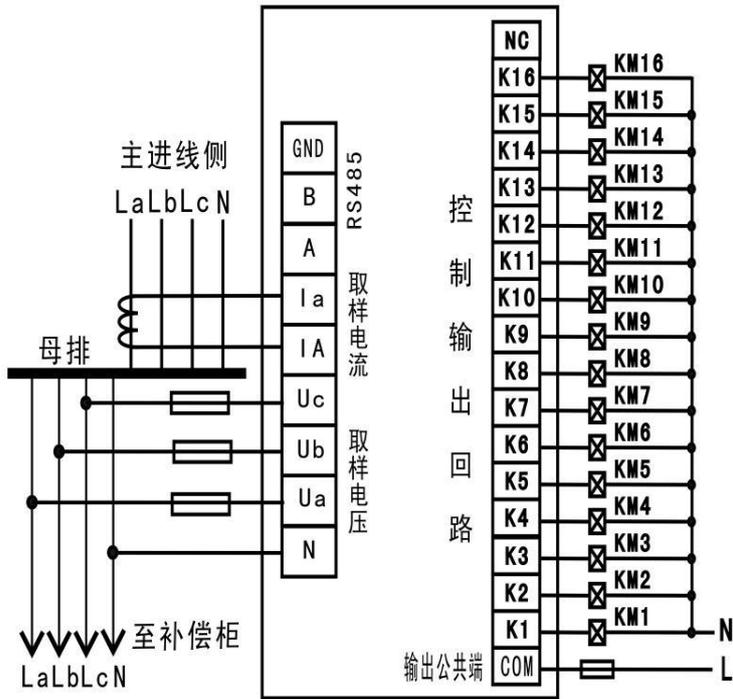
控制晶闸管开关或复合开关
